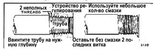
РИС. 5 – ИСПОЛЬЗУЙТЕ УМЕРЕННОЕ КОЛИЧЕСТВО КОМПАУНДА ДЛЯ ТРУБ.
