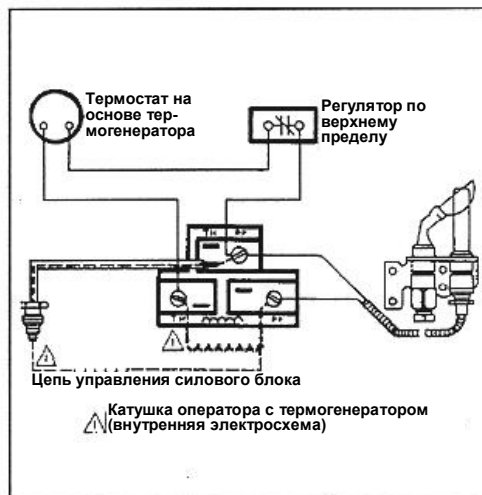
РИС 11 – ТИПОВАЯ СХЕМА ЭЛЕКТРИЧЕСКИХ СОЕДИНЕНИЙ ДЛЯ УСТРОЙСТВА С ОПЕРАТОРОМ С ТРЕМЯ ВЫХОДАМИ
